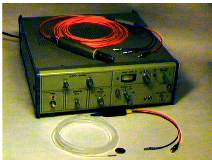
Рис. 3.5. Эндоскопический оптический когерентный томограф со сменными оптоволоконными зондами
