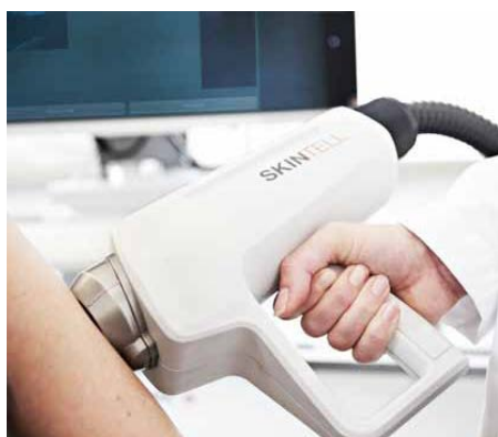
Рис. 3.3. Портативный датчик оптического когерентного томографа SKINTELL
