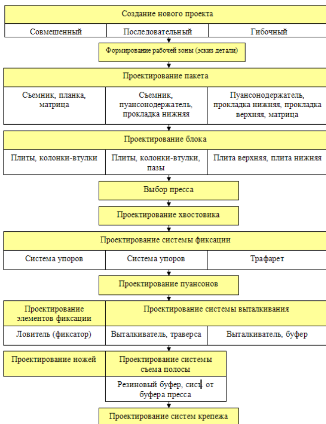
Рис. 18. Примерный порядок проектирования штампов различных типов
