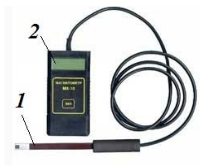
Рис. 3.7. Магнитометр остаточной намагниченности МХ-10: 1 – преобразователь Холла; 2 – электронный блок
