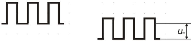
Рис. 1.6. Определение постоянной составляющей импульсного сигнала
