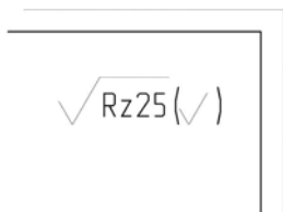
Рис. П4. Указание шероховатости, одинаковой для части поверхностей детали
