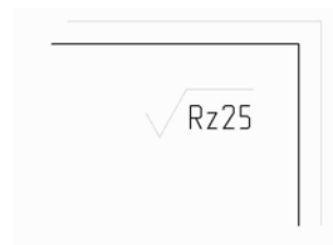
Рис. П5. Указание шероховатости, одинаковой для всех поверхностей детали
