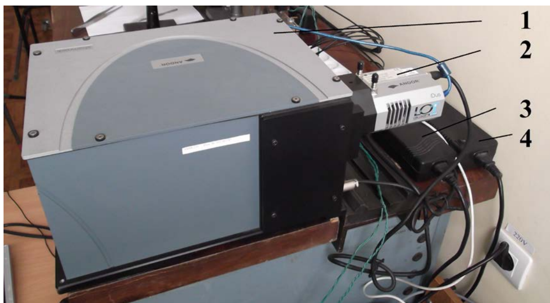
Рис. 3.6. Спектрометрический комплекс: 1 – спектрометр Shamrock sr-303i; 2 – встроенная охлаждаемая камера DV420A-OE; 3 – источник питания спектрометра; 4 – источник питания камеры
