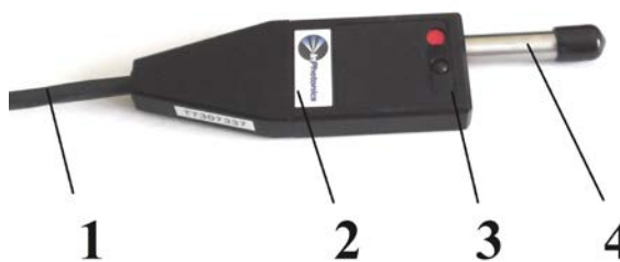
Рис. 3.4. Рамановский пробник RPB785: 1 – оптоволоконный жгут; 2 – блок фильтров; 3 – движок управления шторкой; 4 – тубус
