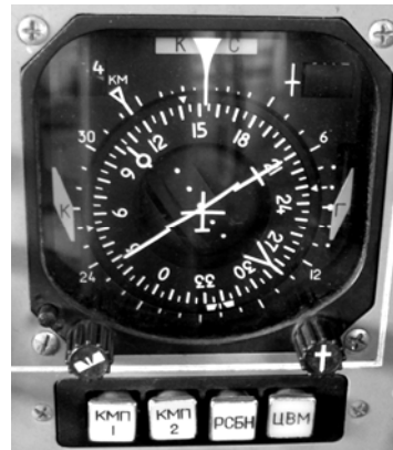
Рисунок 11 Лицевая панель прибора ПНП-72 и пульт управления ПУ-1П 1 - пульт управления, 2 - кремальера задатчика дальности, 3 - бленкер канала курса, 4 - шкала отклонений от равносигнальной зоны курса, 5 - неподвижная шкала, 6 - подвижная (магнитная) шкала, 7 - индикатор заданных путевых углов курса, 8 - стрелка-указатель курсовых азимутальных углов, 9 - бленкер каннала глиссადы, 10 - индикатор отклонения самолета от равносигнальной зоны глиссадды, 11 - шкала отклонения самолета от равносигнальной зоны глиссадды, 12 - планка отклонения по курсу от равносигнальной зоны, 13 - кремальера задатчика путевого угла.
