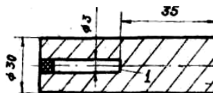
Рис. 1.7. Конструкция эталона чувствительности
