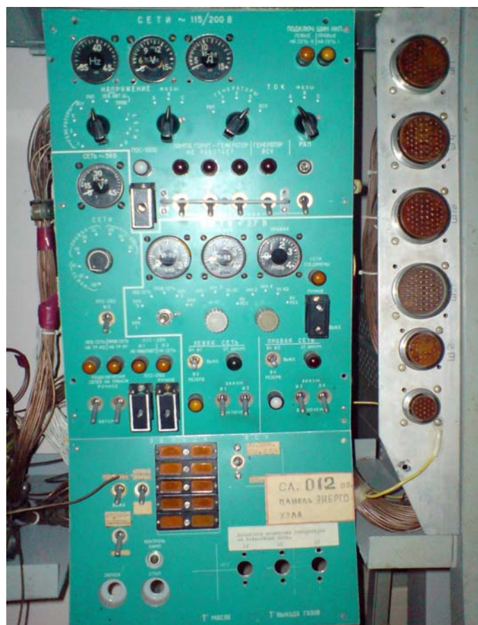
Рисунок 2.1 – Панель энергоузла и запуска ВСУ самолёта Ту-154
