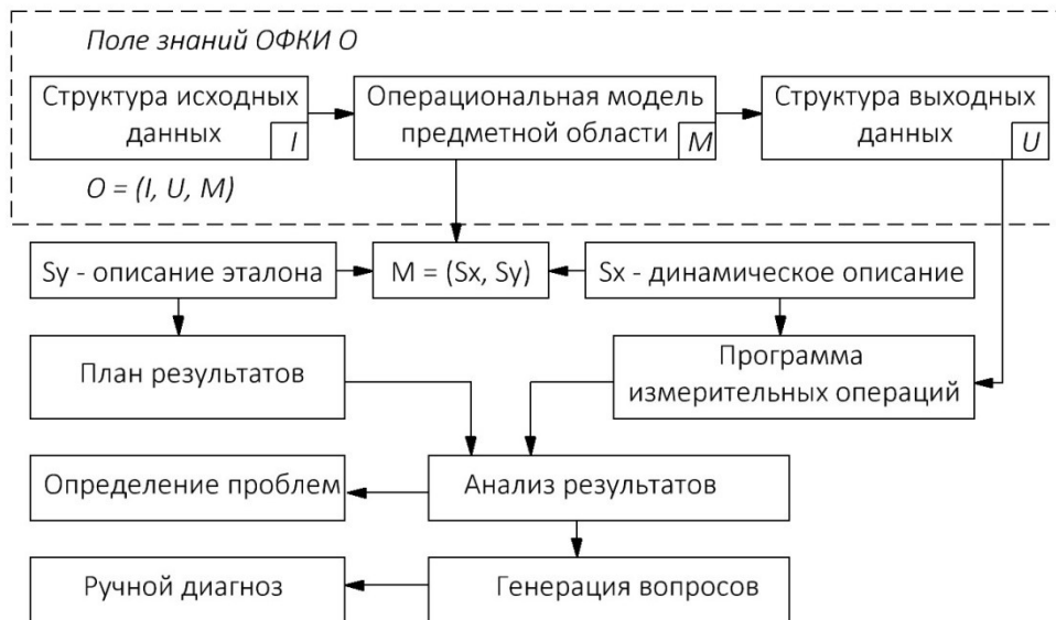
Рис. Обобщенная структурная схема организации операционного комплекса контроля и испытаний агрегатов
