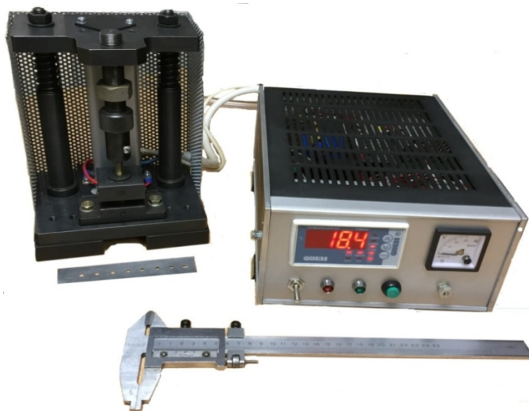
Рис. 2. Пресс с многозвенным силоприводом
