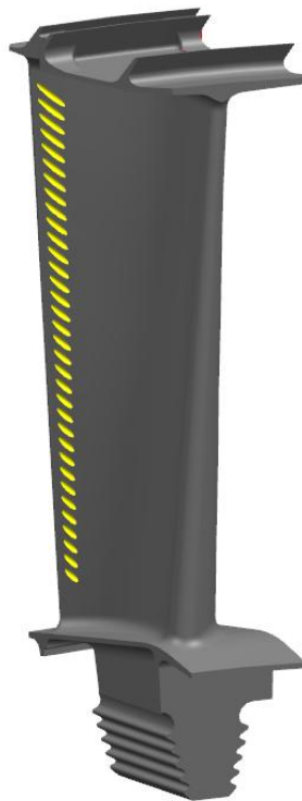
Рис. 1. 3D модель турбинной лопатки 152.426.001
