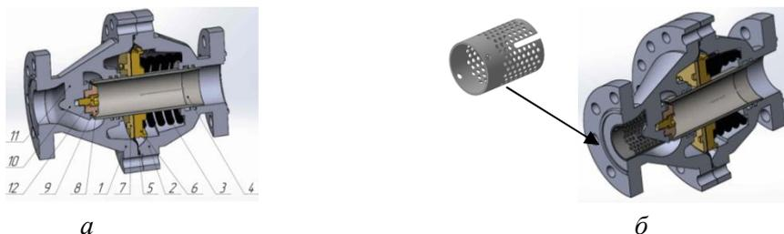
Рис. 1. Внешний вид РДУ без перфорированной втулки (а) и с втулкой (б):
