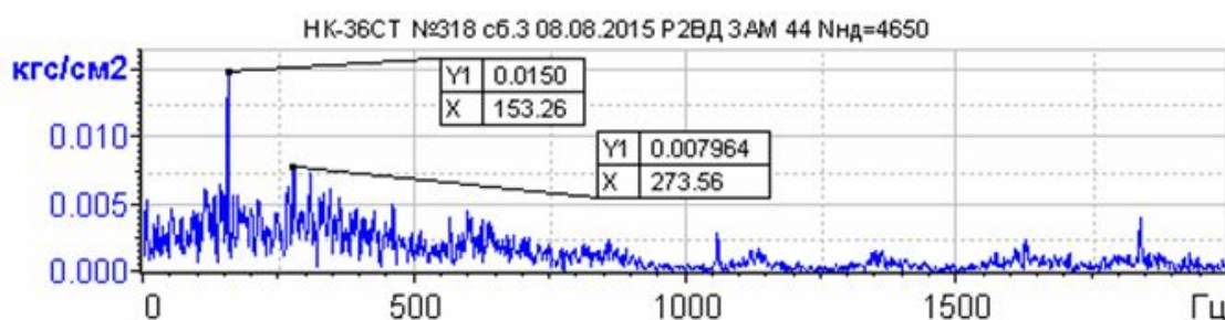
Рис. 2. Амплитудный спектр пульсаций давления за компрессором двигателя НК-36СТ, зарегистрированный зондом с акустическим демпфером при среднем давлении 18 кгс/см 2
