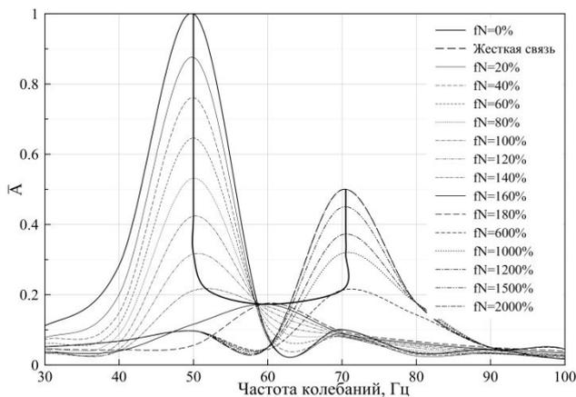
Рис. 3. Амплитудно-частотная характеристика колебаний системы при различных значениях силы трения
