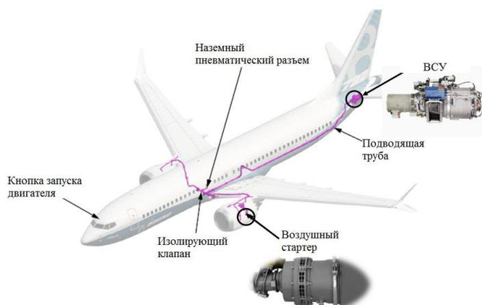
Рис. 1 – Принципиальная схема системы запуска с ТСВ
