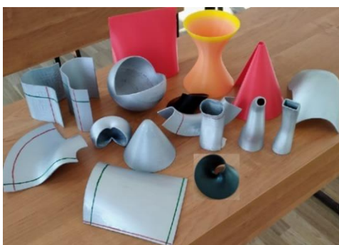
Рис. 1 – Комплект моделей кинематических поверхностей (фрагмент)
