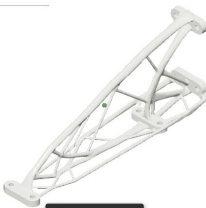
Рис. 2 – Дизайн кронштейна после генеративного метода проектирования
