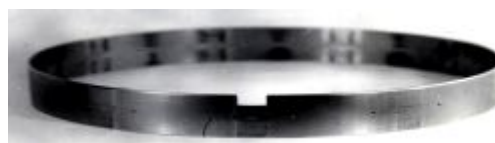
Рис. 2. Упругое кольцо с дросселирующими канавками
