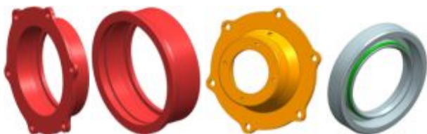
Рис. 3. Параметрические 3D модели стаканов, крышек и манжет
