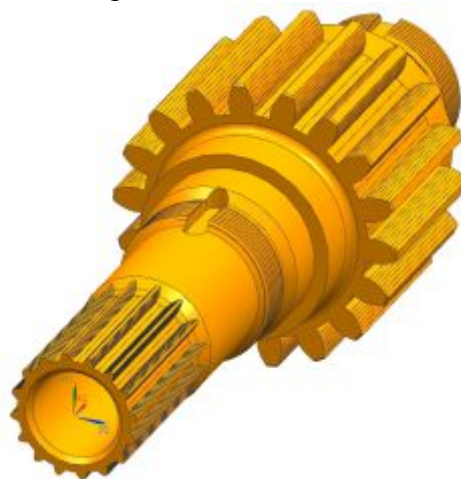
Рис. 1. Объёмная модель вала-шестерни, построенная с использованием 3D ПРМ
