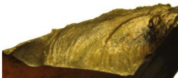
Рис. 2. Макрорельеф поверхности излома вала
