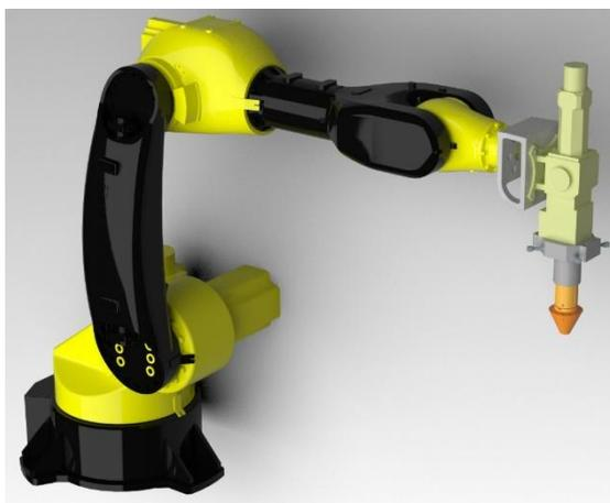
Рис. 1 – 3D-модель шестиосевого робота-манипулятора с наплавочным узлом
