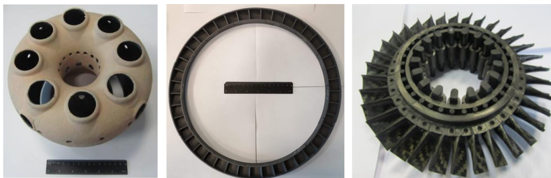
Рис. 1 – Разработанные и изготовленные жаровая труба из \text{C}_f/\text{SiC} , сопловой аппарат из ДУКМ, заготовка колеса турбины из \text{C}_f/\text{SiC}
