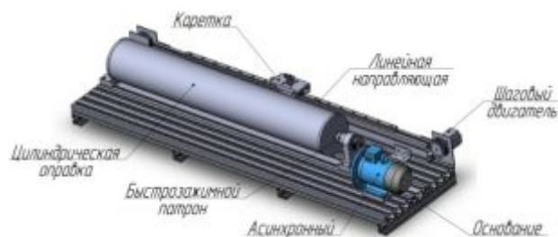
Рис. 2. 3D модель разработанной в Solid Works установки
