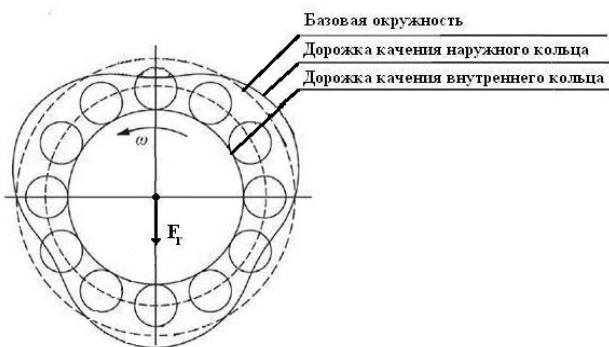
Рис. 1. Подшипник с тремя выступами на дорожке качения наружного кольца
