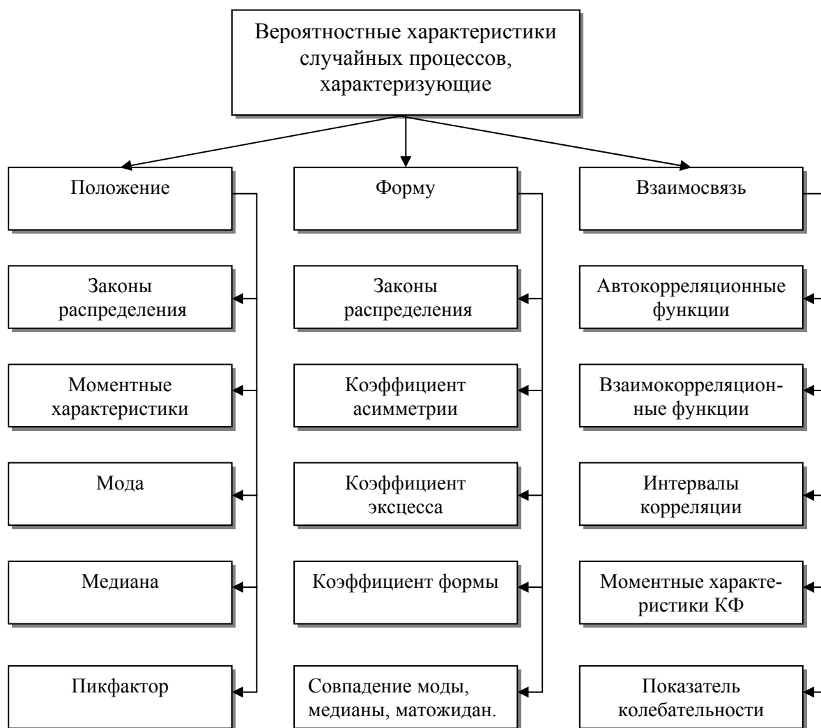
Рисунок В.1. Классификация вероятностных характеристик случайных процессов
