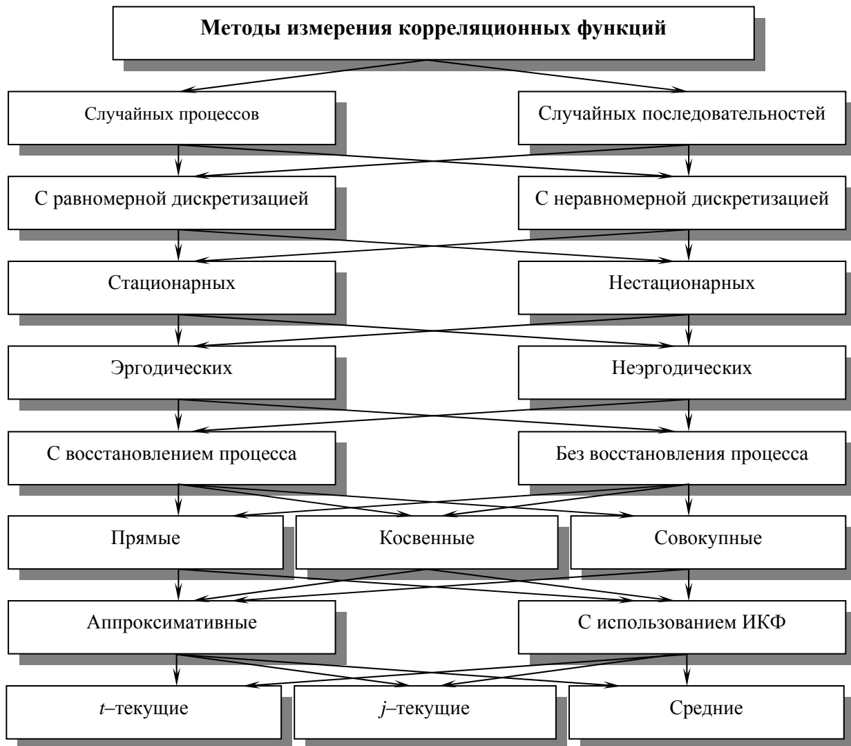
Рисунок 5.2. Классификация методов измерения корреляционных функций неэвиди-стантных временных рядов
