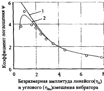
Рис. 2.38. Зависимости коэффициента поглощения для демпферов с линейным (1) и угловым (2) смещением вибратора
