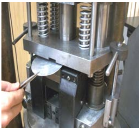
Рис. 6.15 – Внешний вид штампа для реализации комбинированной технологии «вытяжка – обрезка припуска»:
