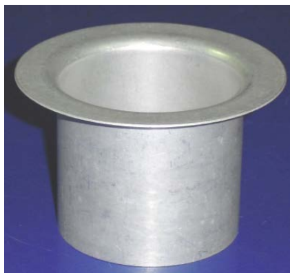
Рис. 3.6 – Схема формовки ( a ); детали с наружным ( б ) и внутренними ( в ) фланцами
