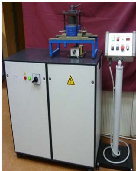
Рис. 11.5 – Варианты конструкций МИУ с энергией 10 кДж
