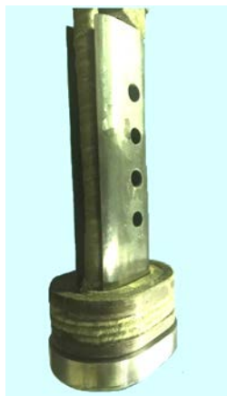
Рис. 6.15 – Внешний вид штампа для реализации комбинированной технологии «вытяжка – обрезка припуска»:
