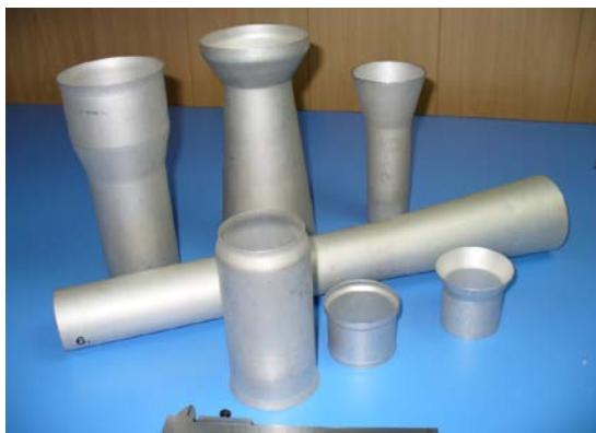
Рис. 3.2 – Примеры трубчатых переходников, полученных магнитно-импульсной формовкой
