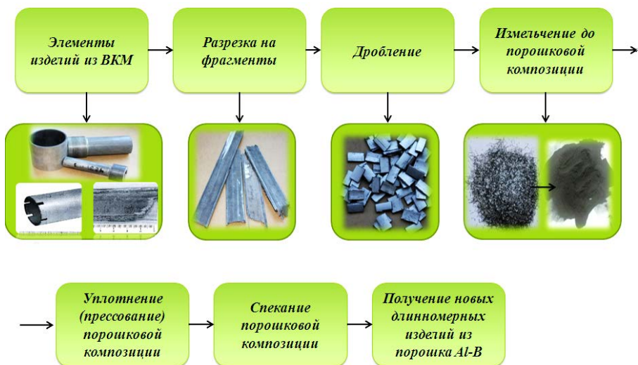
Рис. 8.1 – Последовательность операций «от утилизации ВКМ до новых изделий»
