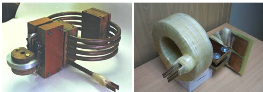
Рис. 13.4 – Трансформаторы кабельного а и обмоточного б типов
