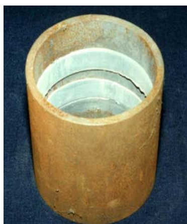
Рис. 5.6 – Сварной стык нефтепромысловых труб с приваренными с помощью ИМП протекторными кольцами
