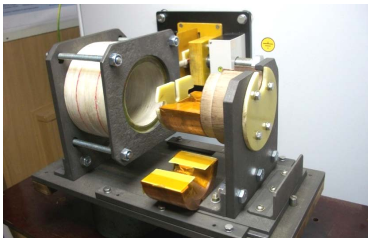
Рис. 13.3 – Разъемный концентратор для сборки кабелей с наконечниками
