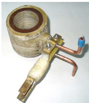
Рис. 13.2 – Охлаждаемый многовитковый индуктор
