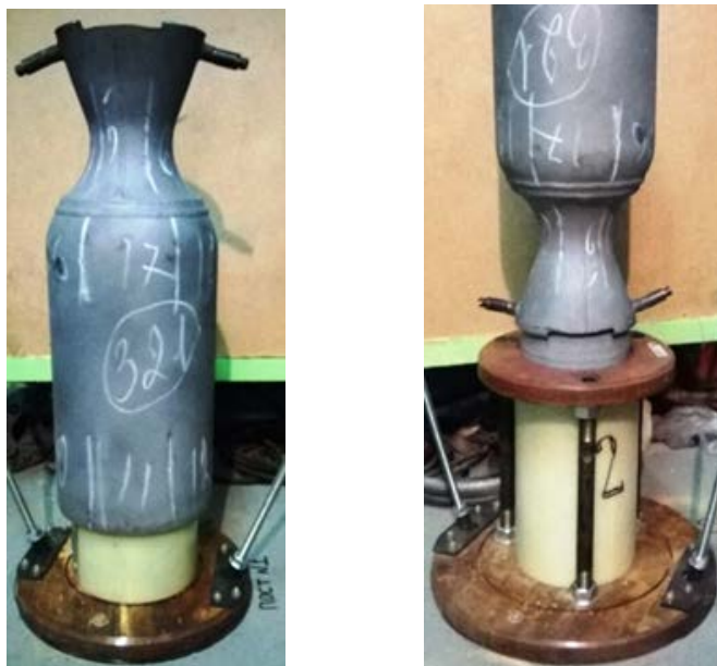
Рис. 4.2 – Собранный с помощью ИМП камера ЖРД
