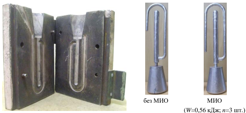
Рис. 7.9 – Комплексная проба Нехендзи-Купцова и полученные с ее помощью на разных режимах пробы из сплава АК9ч
