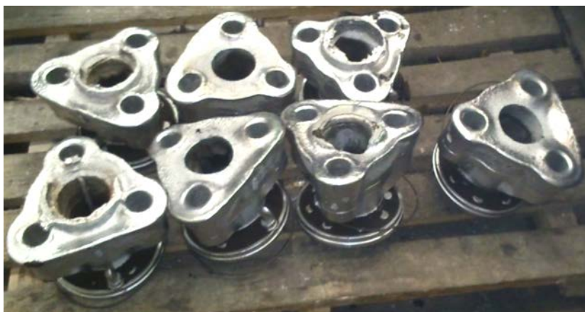
Рис. 7.11 – Опытная партия отливок типовой детали, полученных с применением технологии МИО расплава в литейной форме
