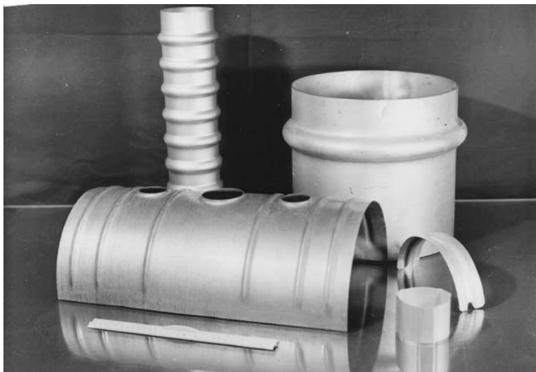
Рис. 3.5 – Детали с рифтами, полученные с использованием ИМП
