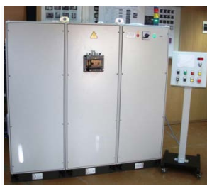
Рис. 11.8 – 6-постовая специализированная МИУ-30
