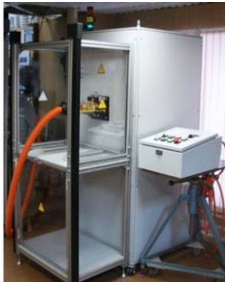
Рис. 11.5 – Варианты конструкций МИУ с энергией 10 кДж
