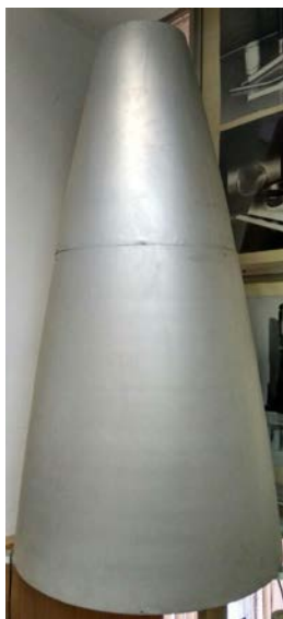
Рис. 3.4 – Обтекатель, изготовленный последовательной формовкой с помощью секционного индуктора
