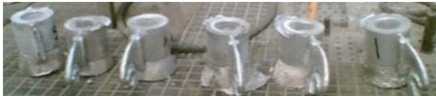
Рис. 7.10 – Опытная партия отливок типовой детали, полученных с применением технологии МИО расплава на этапе его приготовления
