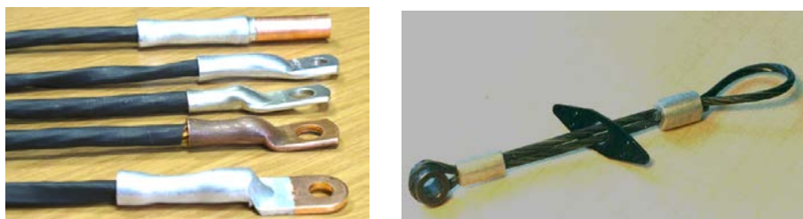
Рис. 4.4 – Сборочные соединения деталей из проволоки: а – электрожгуты с наконечниками; б – страховочный трос альпиниста
