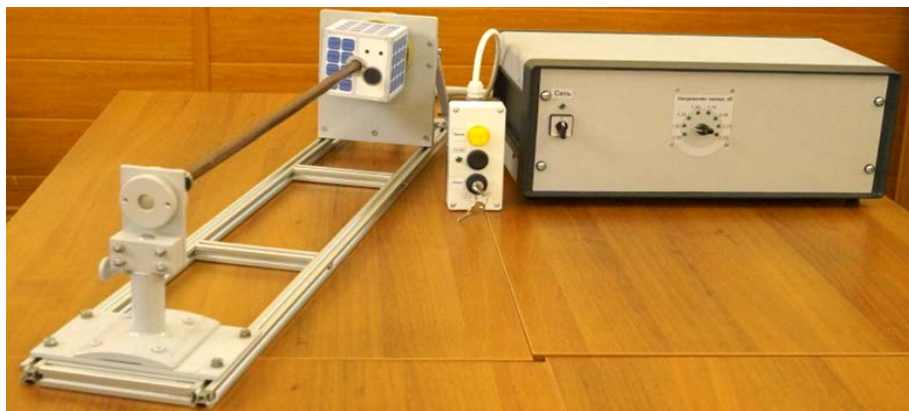
Рис. 10.4 – Испытательный стенд с макетом наноспутника
