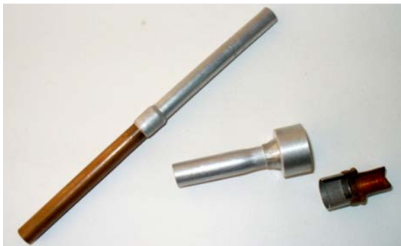
Рис. 5.3 – Сваренные детали двигателей и холодильных агрегатов из однородных и разнородных материалов
