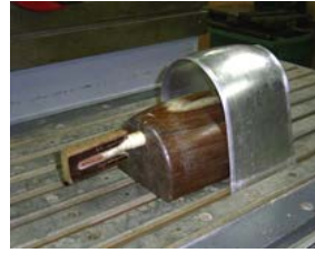
Рис. 6.4 – Схема гибридной технологии обтяжки: 1 – заготовка; 2 – встроенный индуктор; 3 – пуансон
