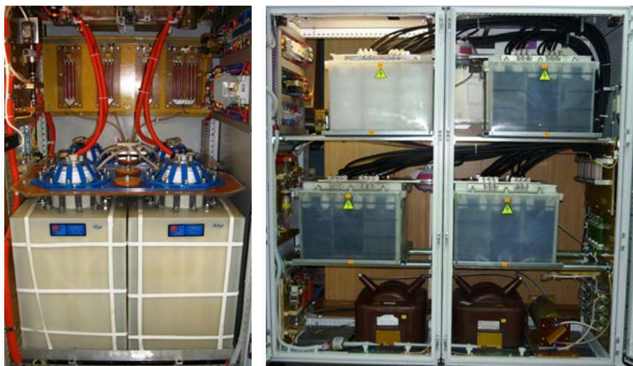
Рис. 11.11 – Конструкция накопителей энергии МИУ: a – энергоблок высокочастотной МИУ-10 (10кДж, 100кГц); б – энергоблок универсальной МИУ-30 (30 кДж, 50 кГц)
