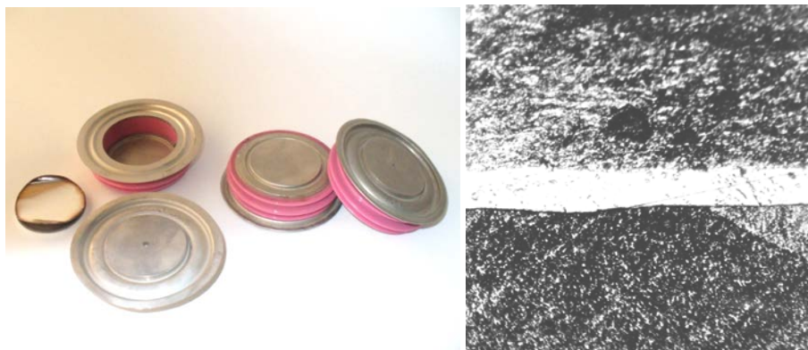
Рис. 5.4 – Тиристор таблеточного типа, полученный с помощью магнитно-импульсной сварки
