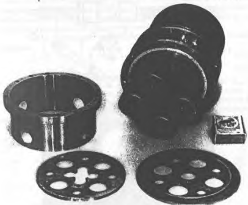
Рис. 4.14. Четырехмодульная СГХМ с приводом "косая шайба"
