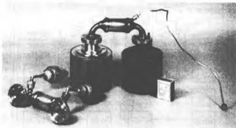
Рис. 4.5. Модуль сильфонного ДВПТ (регенератор с датчиками давления)
