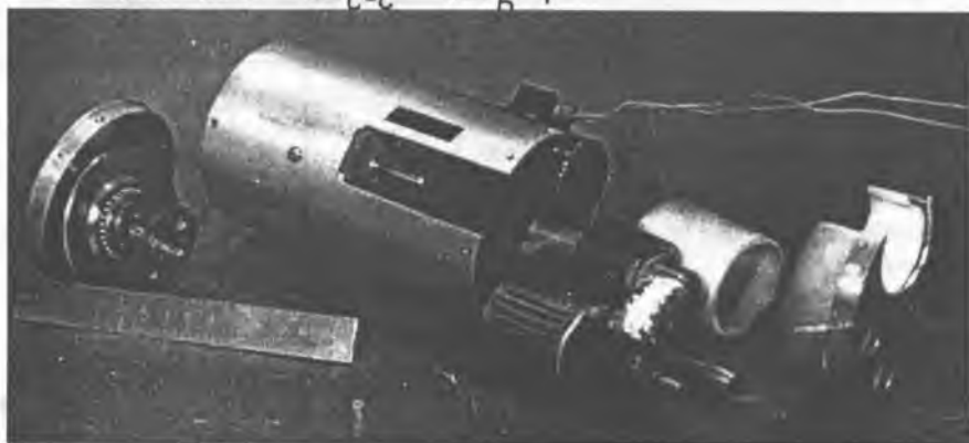
Рис. 4.15. Одномодульная СГХМ с приводом "косая шайба"
