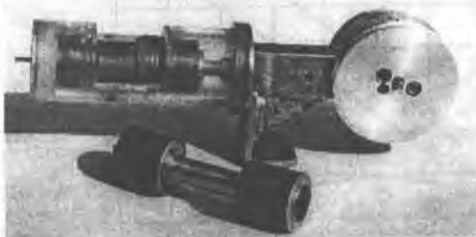
Рис. 4.18. Резонансная СГХМ, а.с. 1177610
