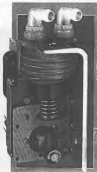
Рис. 1.2. Сильфонный насос фирмы "Gorman-Rupp Industries", США
