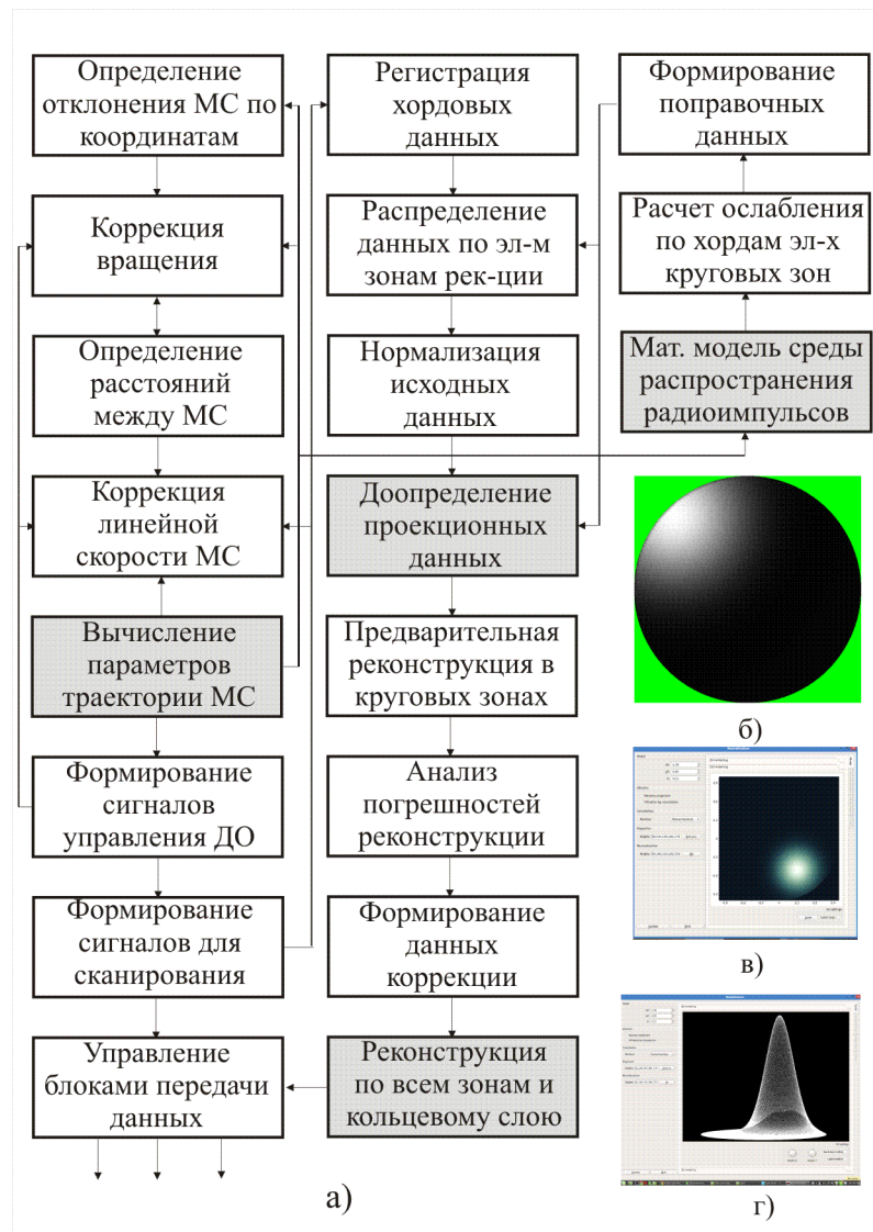
Рис. 2 Структурная схема ППП для реконструкции ПЭС на кольцевом носителе
