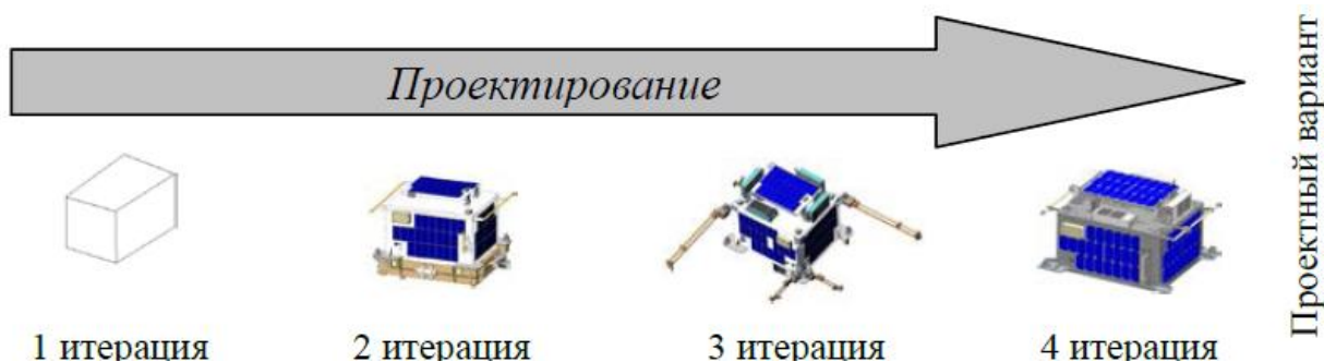
Рис. 3 - Итерационная схема проектирования малого КА
