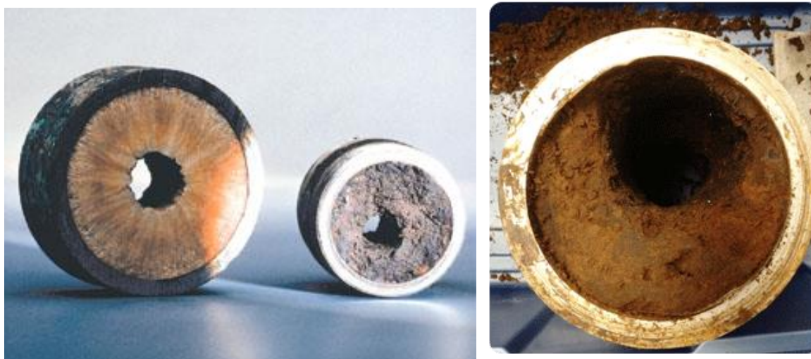
Рис. 1. Образцы срезов нефтепроводов с парафиновыми отложениями
