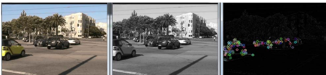
Рис. 3. Применение адаптивной модели фона и алгоритма SIFT
