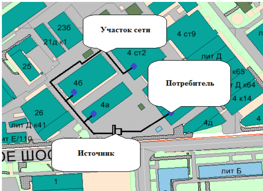
Рис. 1. Дислокация сети теплоснабжения
