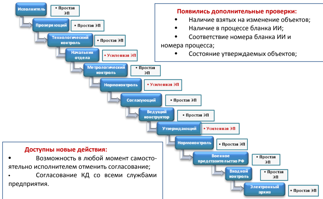
Рис. 4. Принципиальная схема процесса согласования КД с ЭП
