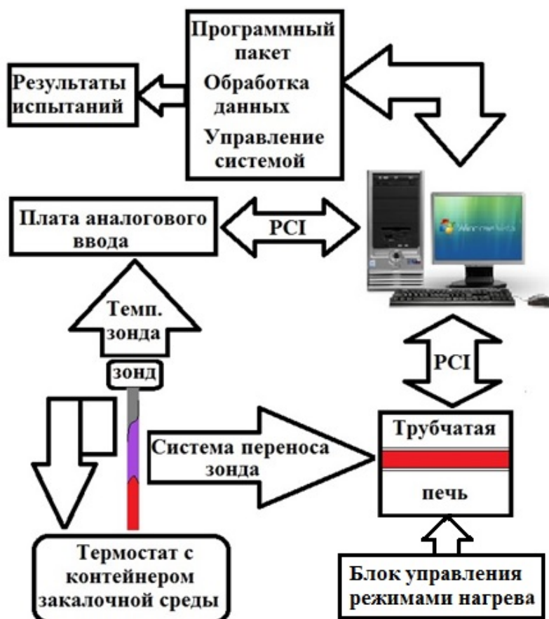
Рис. 1. Общая схема информационно-измерительной системы по определению охлаждающей способности закалочных сред
