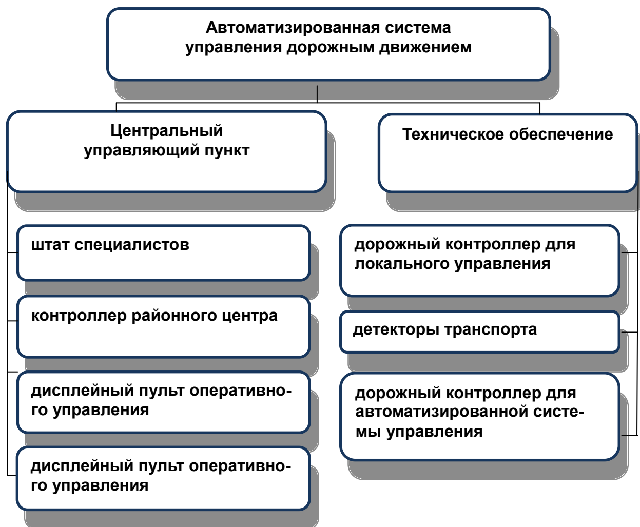
Рис. 1. Архитектура автоматизированной системы управления дорожным движением
