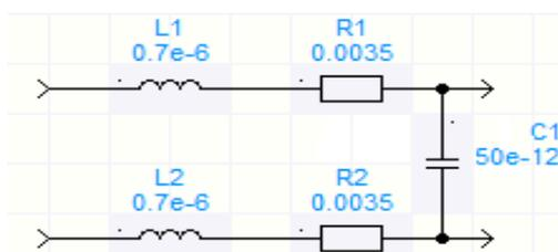
Рис. 1. Модель двухпроводной линии (фрагмент 1 м)
