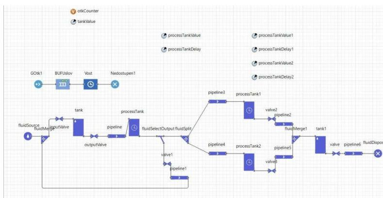
Рис. 1. Схема модели линии обработки зерна
