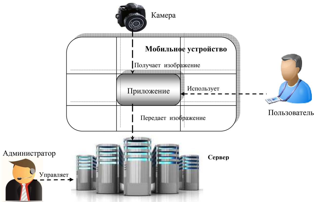
Рис. 1. Схема взаимодействия устройства с сервером
