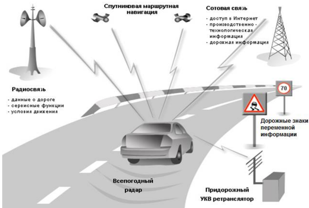
Рис. 1. Структурная схема обмена информацией V2I
