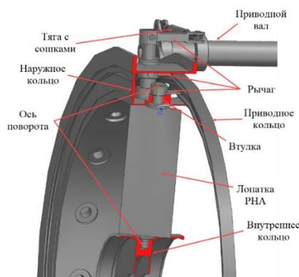
Рисунок 1 - Модель системы РНА авиационного газотурбинного двигателя
