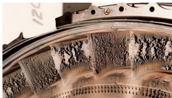
Рисунок 1 - а) изменение площади проходного сечения при аккумуляции отложений на поверхностях лопаток турбины; б) двигатель RB211-524D4, вулкан Галунггунг, Индонезия, 1982 г.
