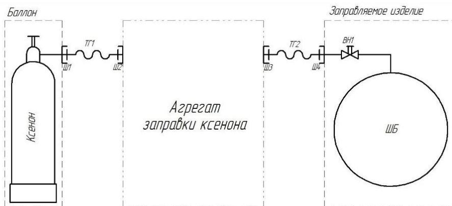
Рисунок 1 – Заправка МКА ксеноном
