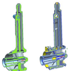
Рисунок 2 – Варианты оптимизированной конструкции горелочного устройства, адаптированной под СЛС
