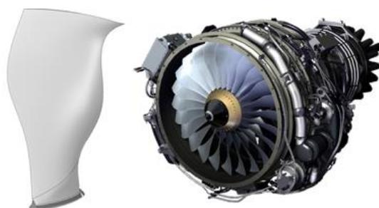
Рисунок 1 – Объект исследования – перо РЛ вентилятора
