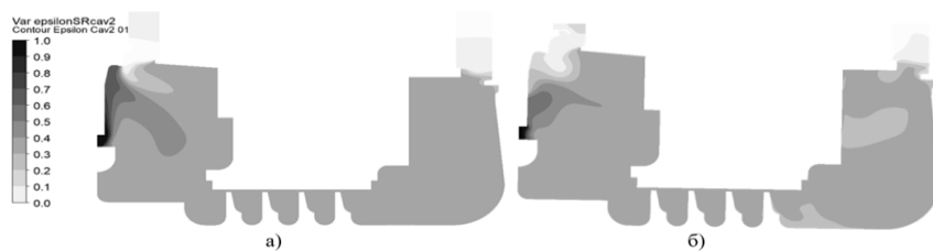
Рисунок 2 - Эюра эффективности концентрации газа для стационарной постановки (а) и для нестационарной постановки (б) для полости №2
