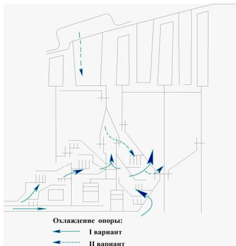
Рис. 5. Два варианта наддува уплотнения опоры турбины
