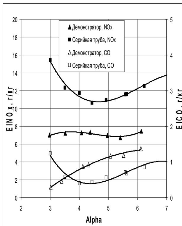
Рис. 1. Зависимость индекса эмиссии оксидов азота и оксида углерода на выходе из серийной жаровой трубы и трубы – демонстратора.
