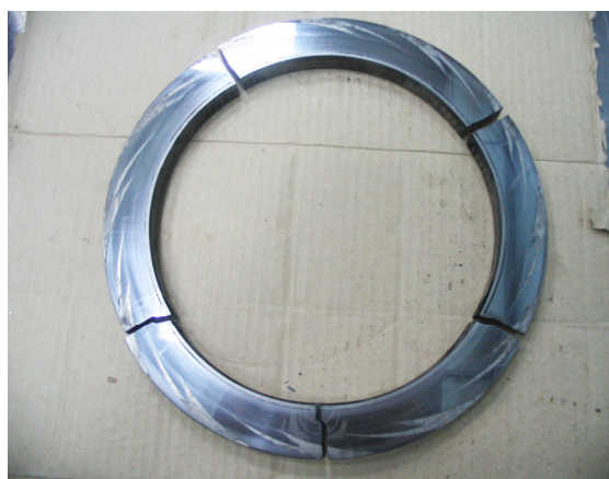
Рис. 1. Разрушившееся кольцо исследуемого уплотнения нагнетателя
